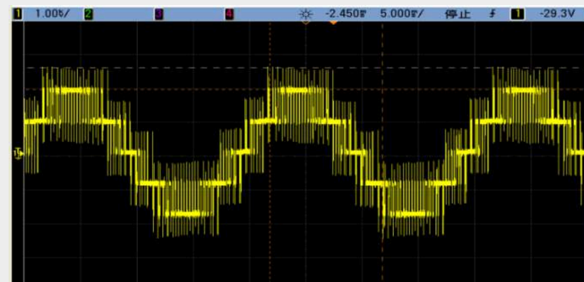
Трёхуровневые пики напряжения 650 В
